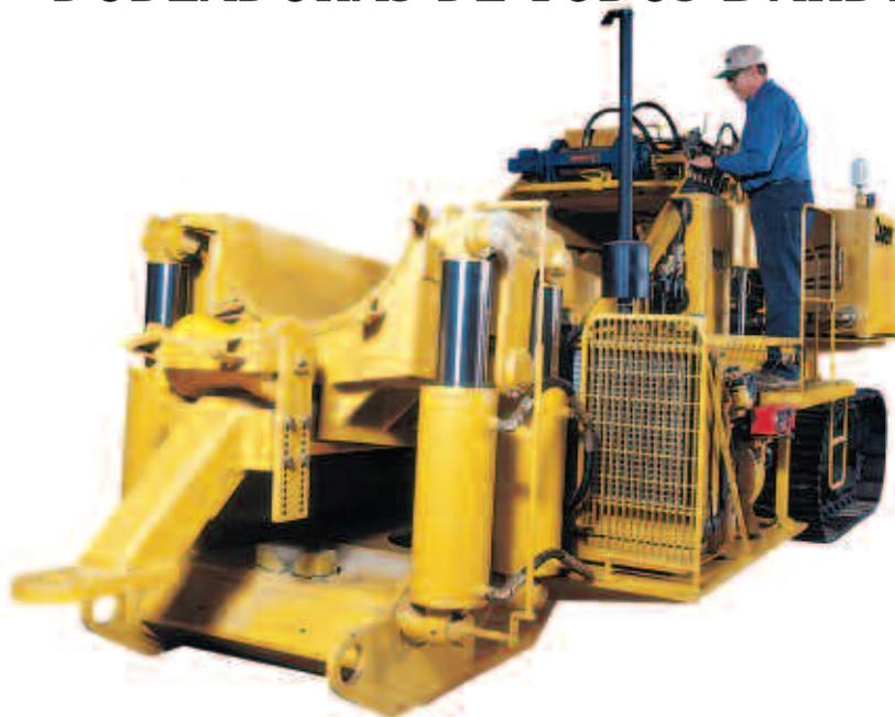
Las máquinas hidráulicas dobladoras de tubo Darby son hoy en día las dobladoras más avanzadas en el mercado. Todos los componentes estructurales están hechos de acero T-1 de alta resistencia y vienen con motores diesel Tier III Caterpillar y compresores de aire Quincy.
